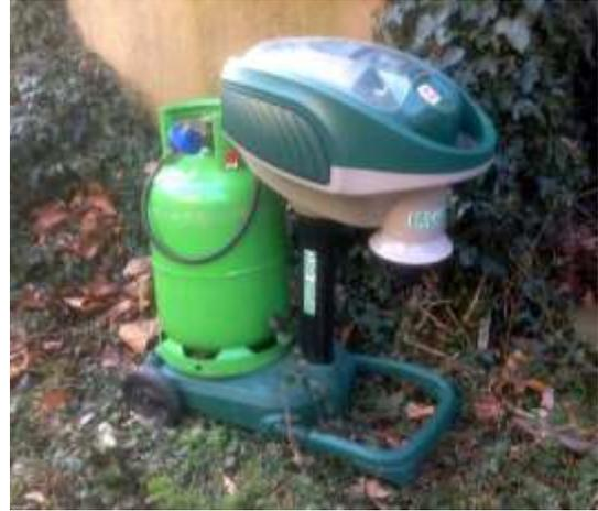
Les femelles à la recherche d'un hôte à piquer sont attirées par l'attractant, le CO<sub>2</sub> et la chaleur (dégagés par la catalyse du propane). En s'approchant de l'entrée, elles sont aspirées par le ventilateur et maintenues dans un filet. Elles peuvent rester plusieurs heures ainsi, avant de mourir desséchées.
