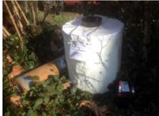
Les femelles à la recherche d'un hôte pour le piquer vont être attirées par l'attractif et le CO2. En s'approchant de l'entrée, elles vont être aspirées par le ventilateur et maintenues dans un filet. Elles peuvent rester plusieurs heures ainsi, avant de mourir desséchées.
